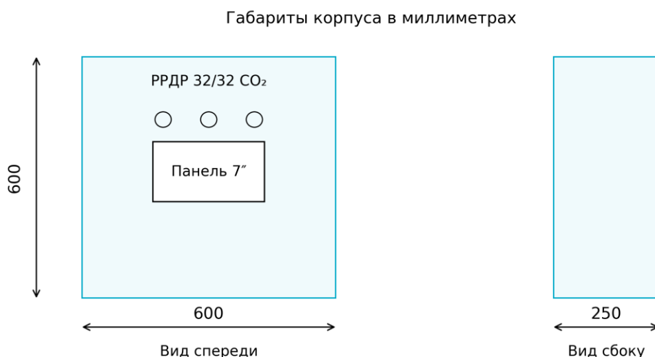
Рисунок 2 — Габаритный эскиз корпуса. Размещение элементов, крепёжные размеры и кабельные вводы — по чертежу поставки.
