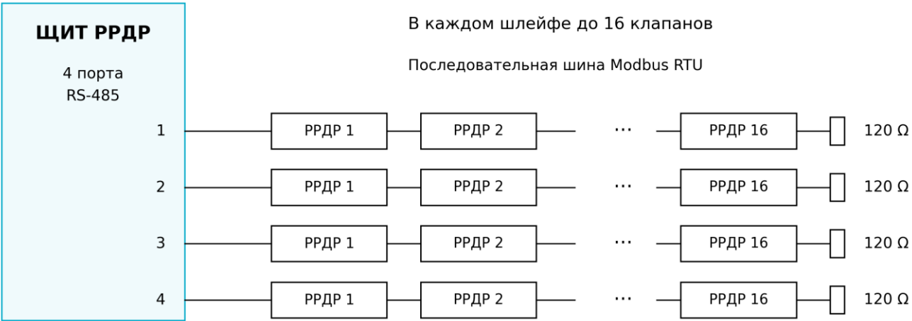
Рисунок 3 — Четыре шлейфа связи. Нумерация устройств на рисунке условная; адреса и клеммы указываются в схемах поставки.
